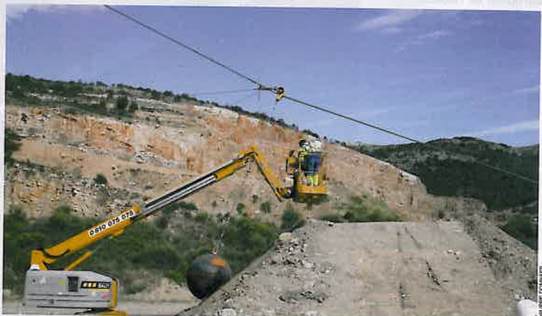
Le dispositif d'expérimentation est constitué d'une sphère en acier de 1,60 m de diamètre, couissant le long d'un câble métallique, qui vient percuter un merlon instrumenté.
