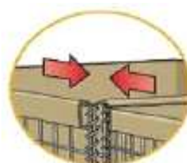
1. Emboîter les deux cellules par les spirales
