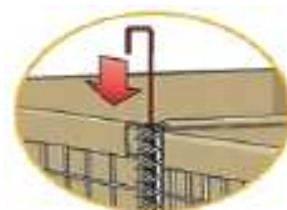
2. Insérer la barrette de jonction au centre des deux spirales
